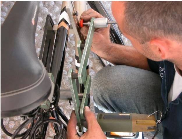
La codifica viene effettuata con un apposito piccolo strumento, il quale imprime meccanicamente sul telaio della bicicletta il codice di sicurezza.
